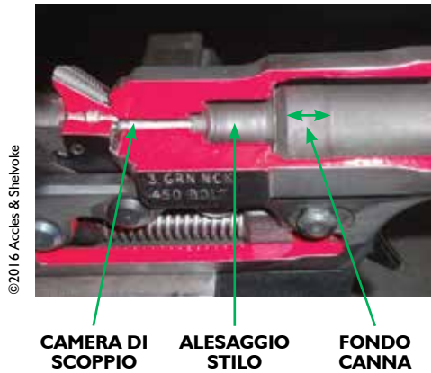
Fig. 8.03 Immagine in sezione di un CASH Special
